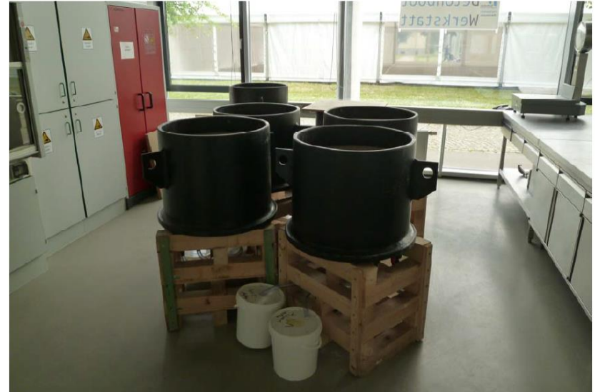
Abbildung 2: Lysimeterversuchsstand Hochschule Magdeburg-Stendal
