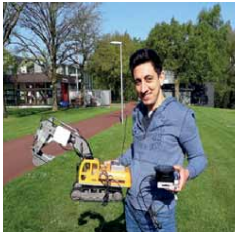
Figuur 5 Onderzoeker S. Asadollahi (verbonden aan de Universiteit Twente) met een prototype van de positiebepalingsmodule en een testuitslag gebruikmakende van een lokaal GIS-referentiestation versus NETPOS. De module is uitgetest zowel op een graafmachine van het SOMA College als in het veld (bron: VELIN)
