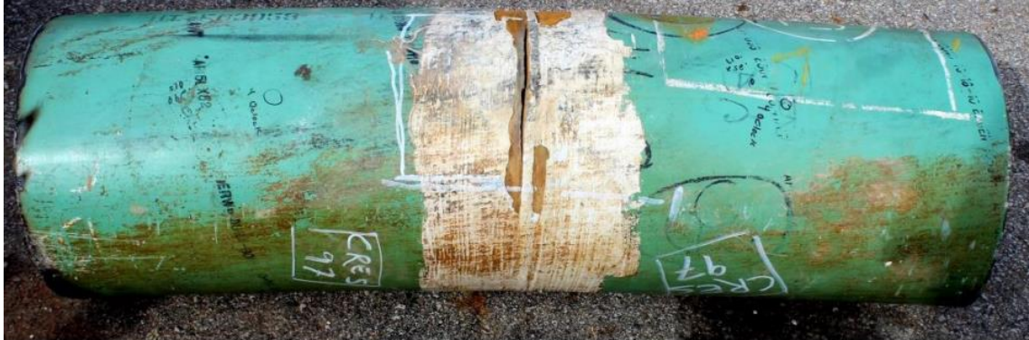
Figuur 3.3: Gescheurde las ten gevolge van buigspanningen (uit presentatie Yong-Yi Wang van CRES).
