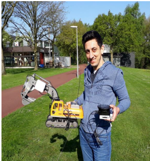
Fig. 5 Onderzoeker S. Asadollahi (verbonden aan de UT) met een prototype van de positiebepalingsmodule en een testuitslag gebruikmakende van een lokaal GIS referentie station versus NETPOS. De module is zowel op een graafmachine van het SOMA college uitgetest alsook in het veld.
